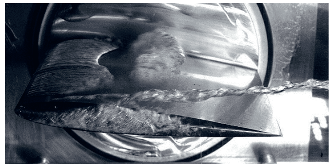
Abb. 3: Verschiedene Arten der Kavitation rund um das NACA0012-Hydrofoil, Schicht- und Wolkenkavitation auf der Druckseite, Spalt- und Spitzenwirbelkavitation im und ausgehend vom Spalt, \sigma = 1.52 , \alpha = 6^\circ , s = 3\text{mm}
