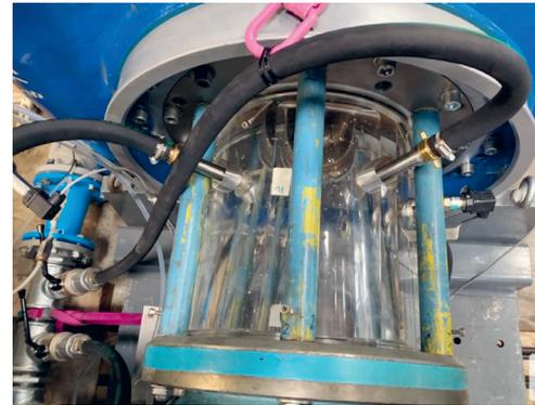
Abb. 2: Injektionsdüsen am Eintritt der Pumpe
