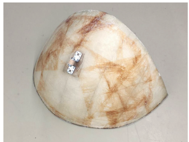
Abb. 3: Mock-Up Bugbereich für die Verifizierung der Arbeitsschritte
