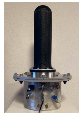
Abb. 3: CFK-Druckkammer mit Temperierboden aus Aluminium
