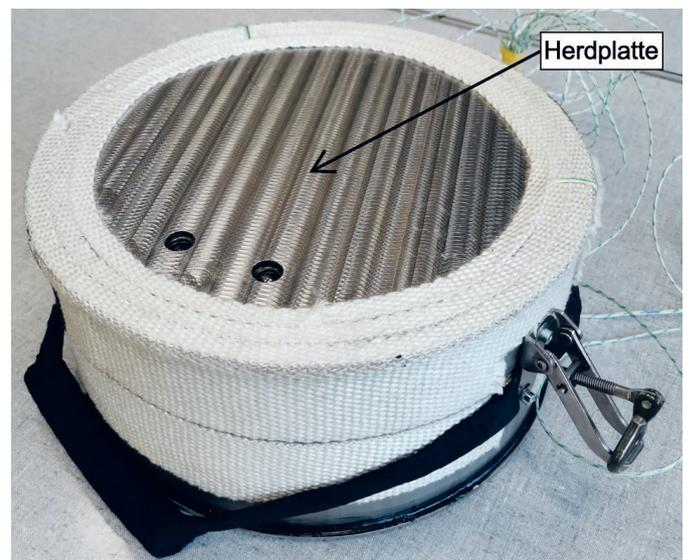
Abb. 3: Funktionsmuster des Solarkochherds mit Latentwärmespeicher, welcher sich unter der Herdplatte befindet
