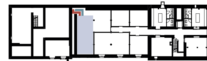
Platzierung Lüftungszentrale | Untergeschoss 1:200
