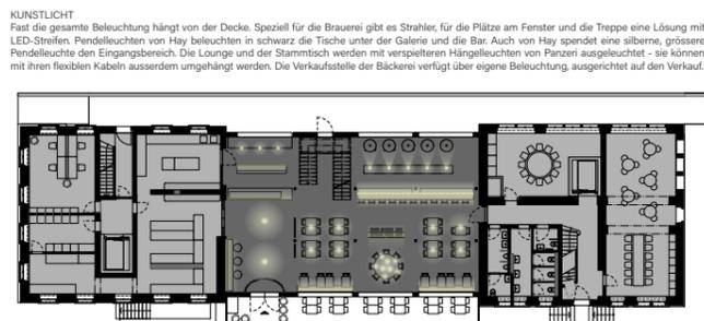
Licht (Erd- und Obergeschoss) | Masstab 1:200
