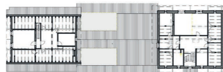
Dachgeschoss Abbruch / Neu 1:300
