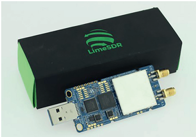
Abb. 1: Eins von drei Software Defined Radios, mit dem die Daten empfangen und versendet werden.
