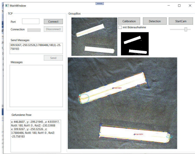
Abb. 2: GUI zur Steuerung der Bilderkennung und Positionsübertragung
