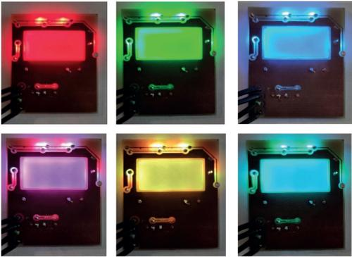
Abb. 2: : Farbmischung und Dimmung der Acrylglaslinse
