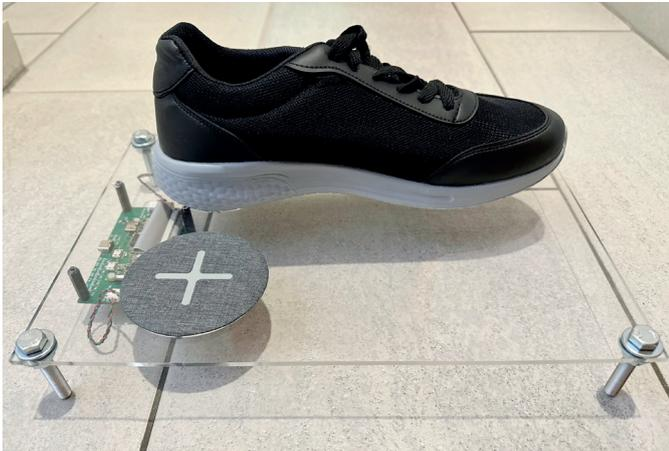
Abb. 1: Intelligente Ladestation während des Ladevorganges eines Schuhs
