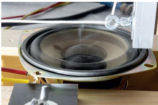
Abb. 3: Langzeitbelichtung (1s) eines angeregten Lautsprechers (100Hz) in einem abgedunkelten Raum. Mit Blitzfrequenz 200Hz und justierter Phase wird die Membran nur an den Extremlpositionen beleuchtet.
