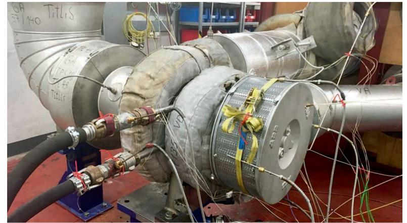
Abbildung 2: Turbolader-Prototyp auf einem Prüfstand
