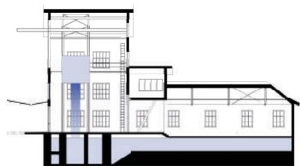
Im Turm konnten verschiedene Gefällhöhen simuliert werden. Ein Rohr führte das Wasser vom Pumpenraum hoch in den Wandertank. So konnte mit Wasserdurchfluss und Wasserdruck experimentiert werden.
