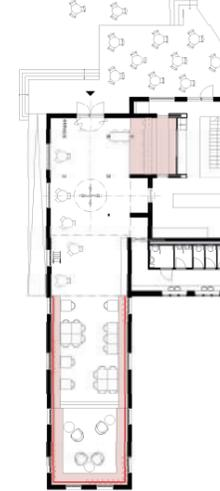
Für die Akustik werden Akustikvorhänge eingesetzt. So kann man die akustische Behaglichkeit vom Gastbetrieb zur Aufführung schnell anpassen. Im Sitzbankbereich unterstützen die Sitzpolster die Akustik. Im Barbereich wird unter dem Deckenputz Baswaphon eingesetzt.
