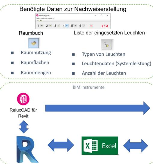
Abb.6 Umsetzung in BIM: Use Case— Beleuchtungsnachweis mittels BIM
