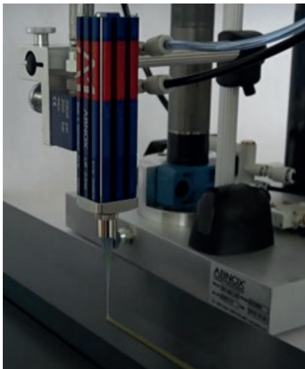
Abb. 1: Schmierstoffdosierung mit zeitgesteuertem Ventil
