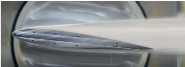
Abb. 1: Strömungsrichtung von links nach rechts, NACA 0012 im Kanal mit sichtbarer Superkavitation und Spaltkavitation, \alpha = 6^\circ , \sigma = 0.55 , s = 1.0 mm
