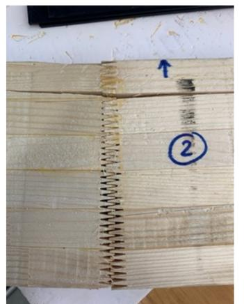
Abb.8: Bruchbild Biegeversuch Fi/Fi
