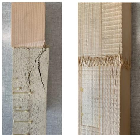
Abb.4: Bruchbild Fi/Purenit Abb.5: Bruchbild Fi/Fi
