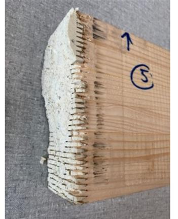
Abb.7: Bruchbild Biegeversuch Fi/Purenit
