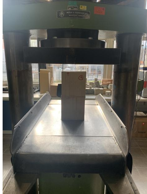
Abb.3: Aufbau Druckversuch
