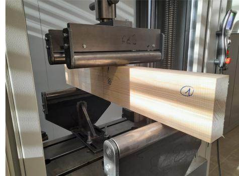
Abb.6: Aufbau Biegeversuch
