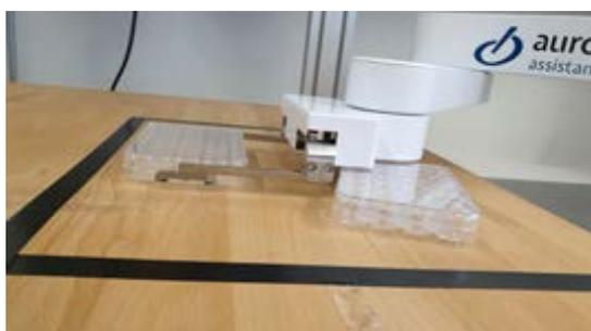
Abb. 3 Greifvorgang der Mikrotiterplatten mittels Roboter
