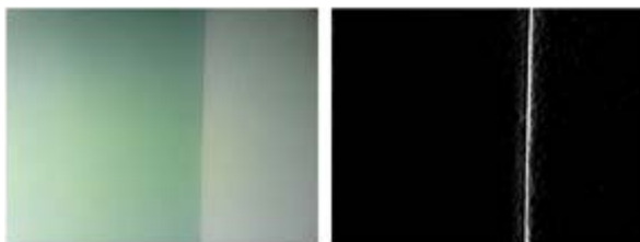
Abb. 3 Kantendetektion mit einem Sobelfilter
