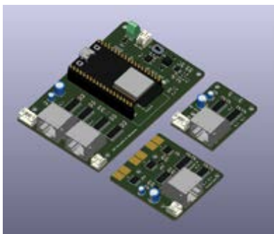
Abb. 3 3D-Ansicht der bestückten PCBs
