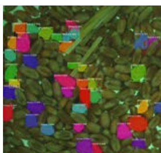
Abb. 4 Resultat der Bildverarbeitung – 42 Steine detektiert
