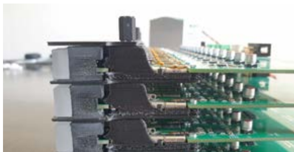
Abb. 3 Mechanischer Aufbau der Pixel-Einheit
