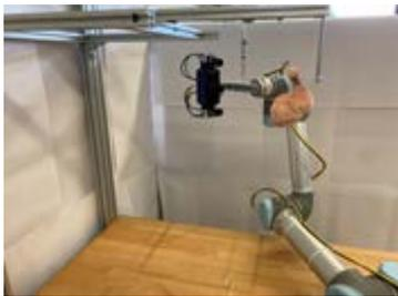
Abb. 2 Roboterbasierte Zelle für 3D Scanning
