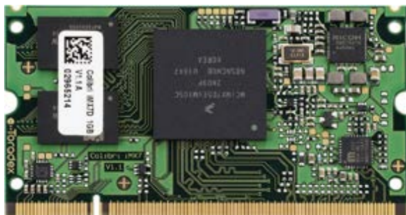
Abb. 1 Toradex Imx7 Modul, auf welchem die Docker Anwendungen laufen
