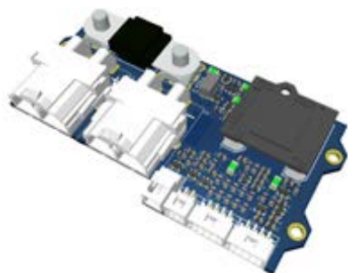
Abb. 3 Überarbeitetes LV-AMS PCB: Überwachung des LV-Akkus
