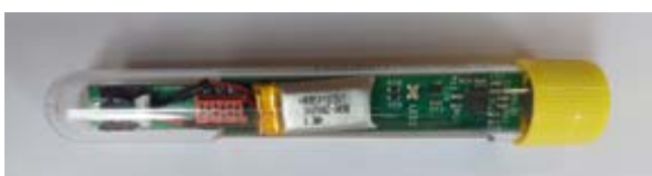
Abb. 4 Datenlogger V2.1 im Probenreagenzröhrchen
