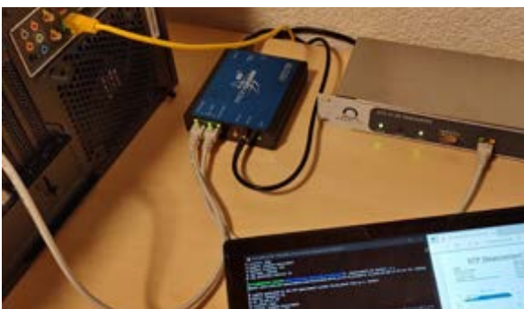
Abb. 2 Versuchsaufbau zum Ausmessen eines Zeitservers
