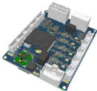
Abb. 2 Pedalbox-PCB zur Integration der Sensoren & Aktoren der Pedalbox
