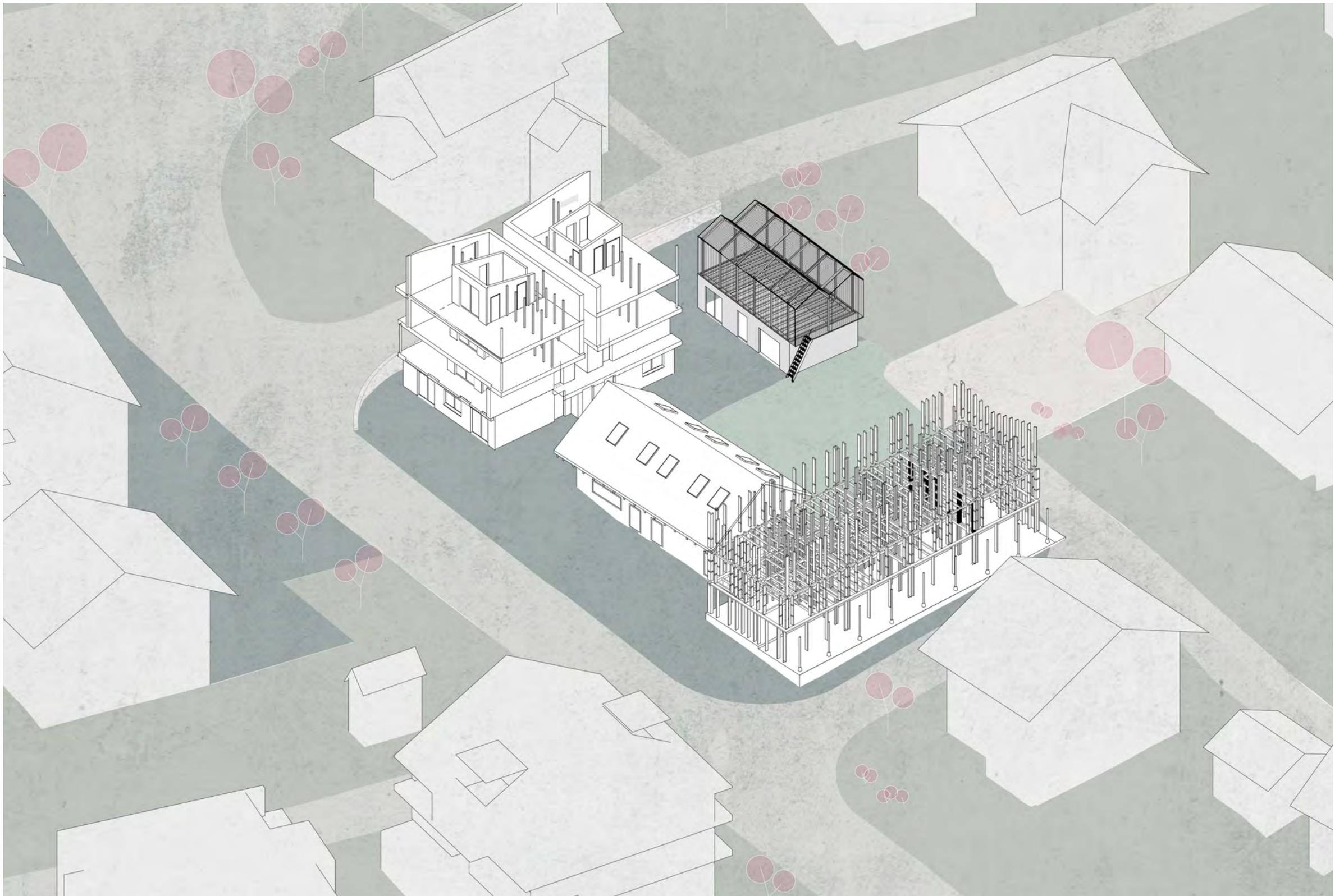
Axonometrie Tragwerk Holzbau
