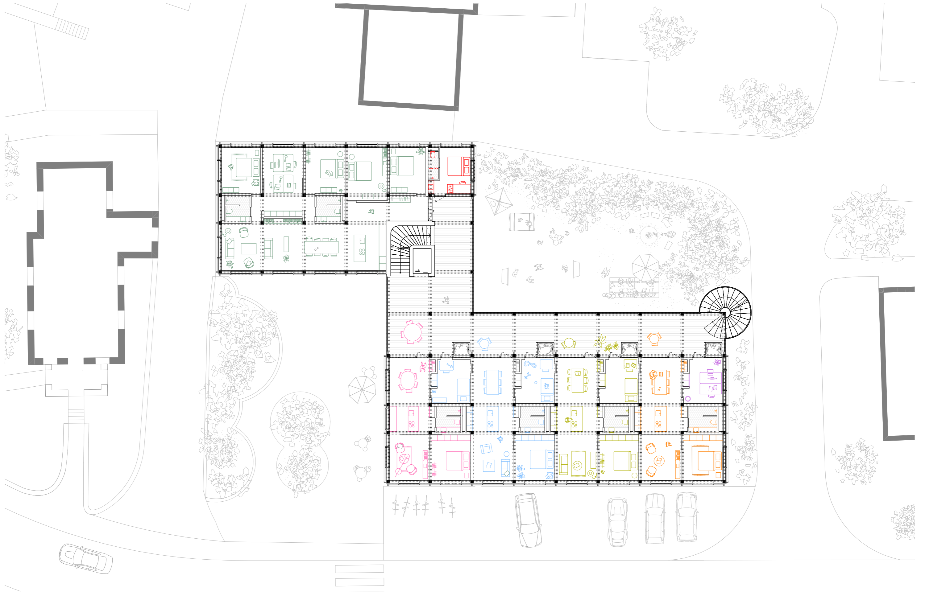
1. Obergeschoss unterteilt in Nutzungsvarianten 1.200
