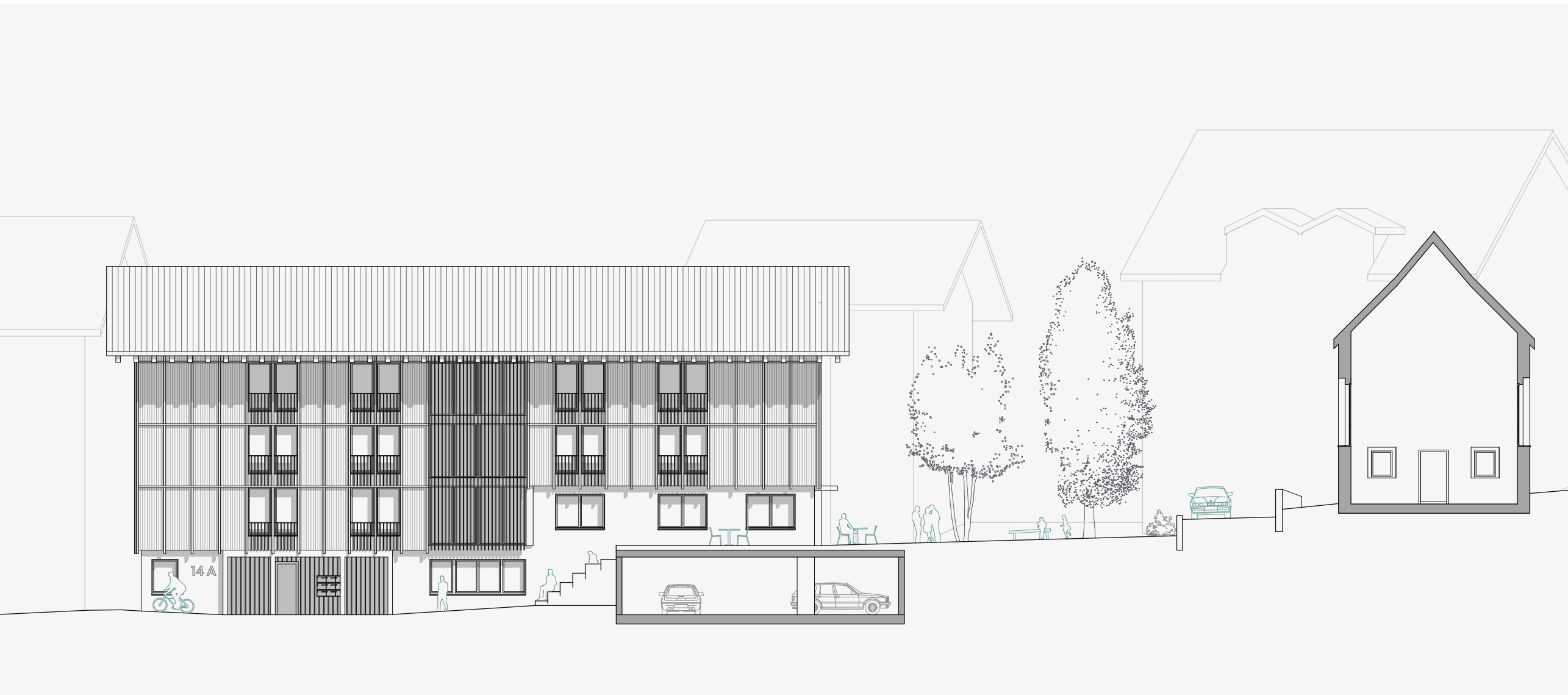
Schnitt durch Einstellhalle mit Ansicht Nord
