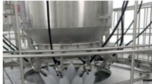
Abb. 2: Kreisförmige Anordnung der Sprühdüsen um die Trocknungskammer
