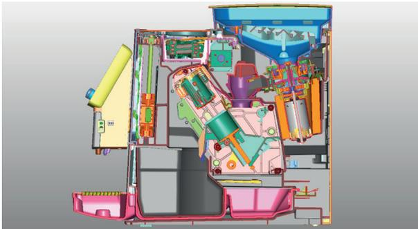
Abb. 1: Schnitt Kaffeemaschine
