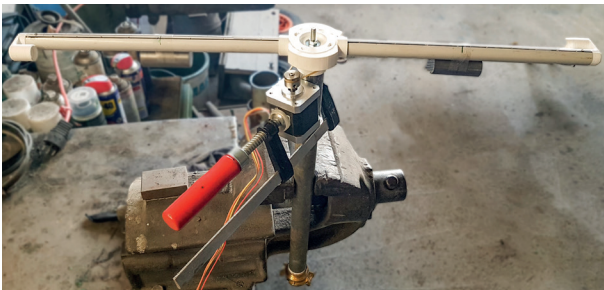
Abb. 1: Vorversuchsaufbau zur Kontrolle des Wascharmes mit einem elektrischen Schrittmotor
