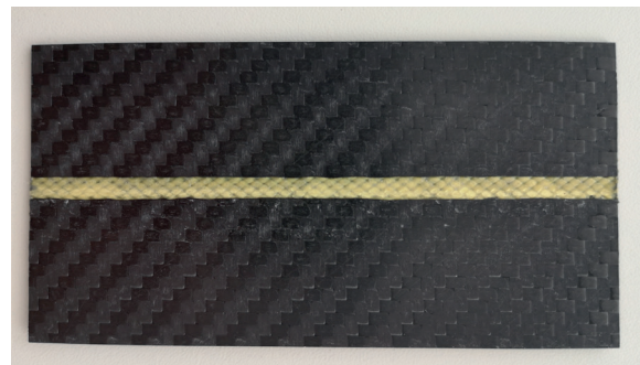
Abb. 3: Kohlenfaser-Kevlar-Scharnier von Pinet Industrie
