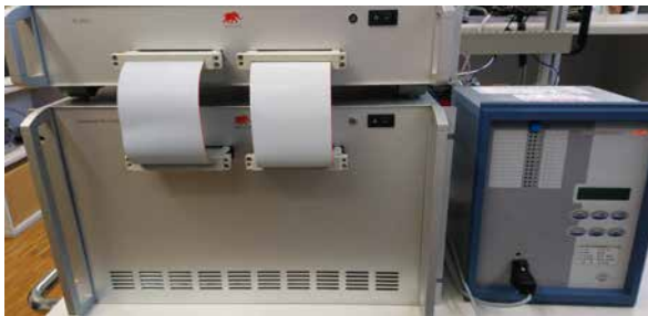
Abb. 1 Die Geräte, die zur Prüfung der Transienten Stabilität verwendet werden. Links ist das Einspeisegerät der Firma Typhoon HIL und rechts das Schutzrelais der Firma Andritz Hydro AG.
