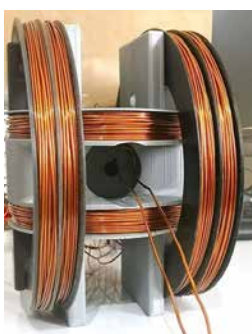
Abb. 4 Realisierter 3-Achsen Magnetfeld-Generator.
