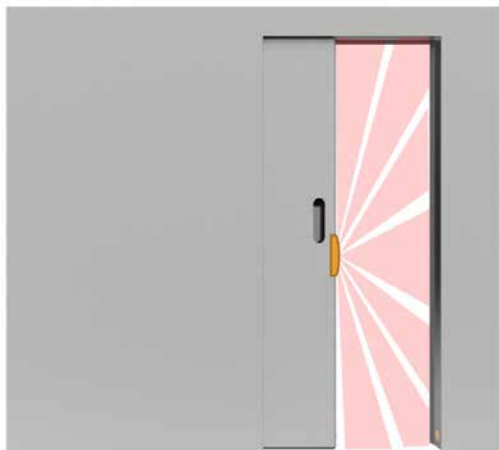
Abb. 1 Schiebetüre mit angedeuteten Sichtfelder der ToF Sensoren
