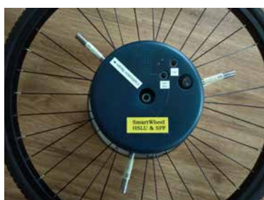
Abb. 4 Aussenansicht der Abdeckung mit Rad inklusive Taster und LEDs
