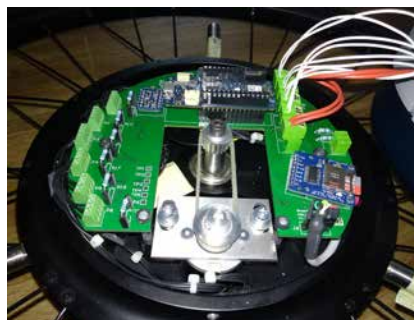
Abb. 3 Innenansicht des Gehäuse mit dem PCB und dem Encoder
