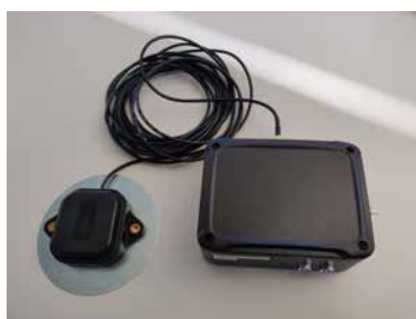
Abb. 1 Realisiertes Funktionsmuster mit externer GNSS Antenne
