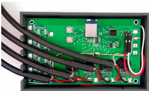
Abb. 4 Funktionsmuster mit integriertem Batteriehalter und Elektronik
