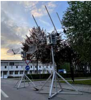
Abb. 1 Die beiden entwickelten Tracker mit den dazugehörigen Richtantennen
