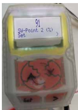
Abb. 3 Prototyp der Displayeinheit des Levelsensors
