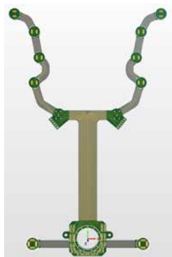
Abb. 2 Modell des Rigid-Flex Lenkrad PCBs
