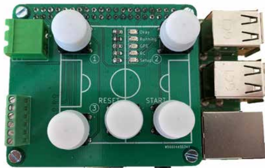
Abb. 3 Raspberry Pi mit HAT (Piloteninterface)
