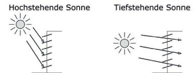
Abb. 3: Funktionsweise eines winkelselektiven Systems
