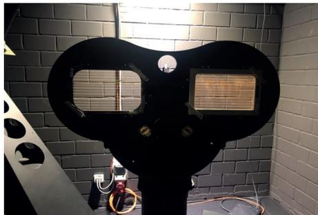
Abb. 2: Musterproben des „MicroLouvre Koolshade“ in der Halterung des Goniophotometer für die optische Messung
