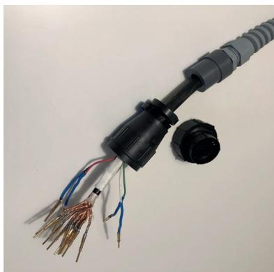
Connector-Kabel einer TMS-Spule
