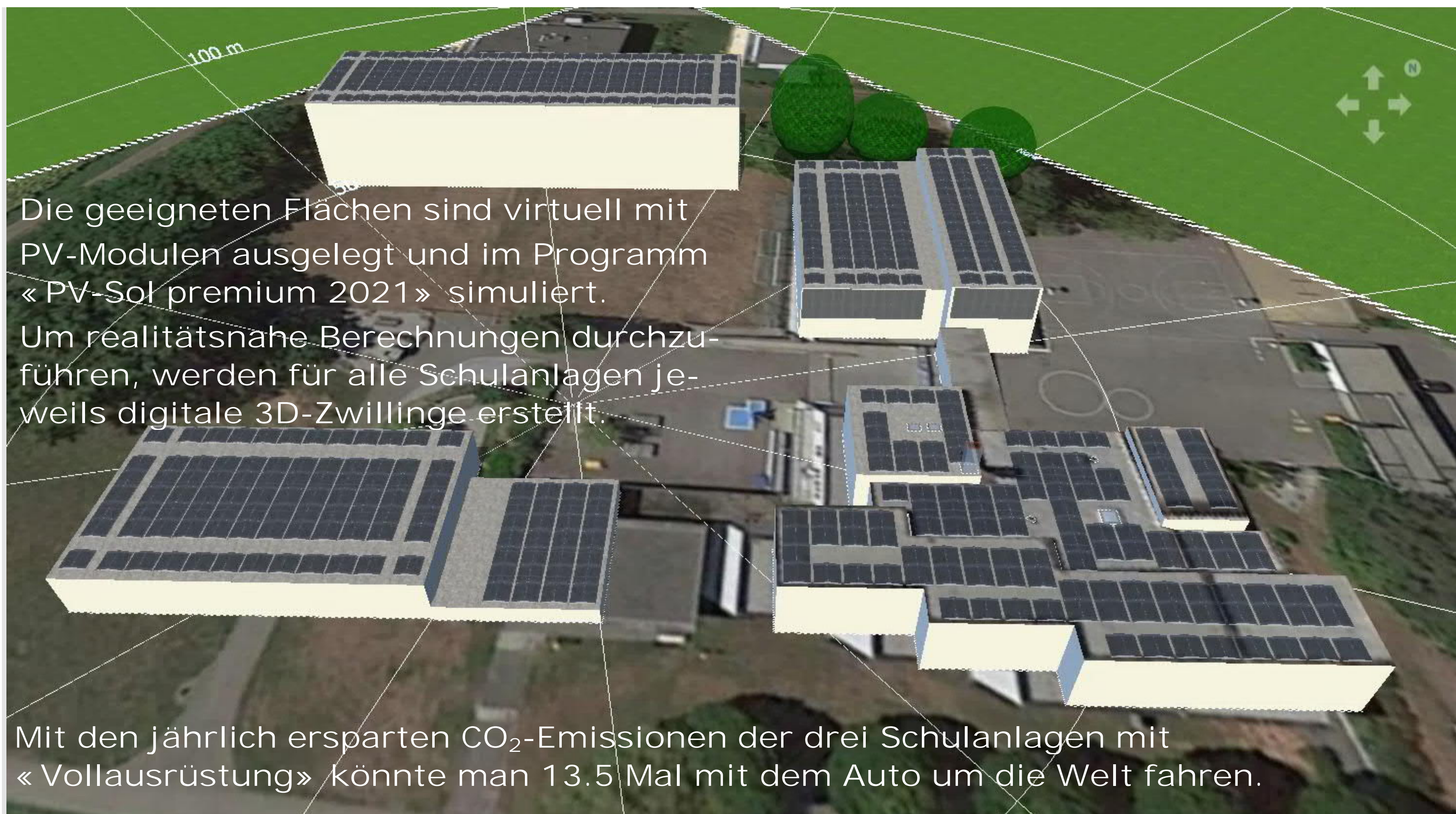
Abbildung: Belegung des Schulhauses Bachwis mit PV-Modulen
